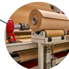
SCARICO AUTOMATICO ROTOLO DA AVVOLGITORE ASSIALE / AUTOMATIC UNLOADING AXIAL WINDING ROLL
